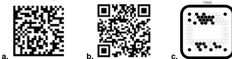
Figur 2: Zwei standardisierte 2D-Barcodes mit der enthaltenen URL http://gis.hsr.ch/wiki : a. DataMatrix (Norm), b. QR-Code (Norm), und BeeTagg (proprietär).
